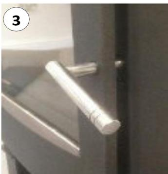
2. Positionnez le levier du contrôle universel de l'air (UAC) sous la porte du poêle de manière à ce qu'il soit à gauche et complètement ouvert (tiré) ; cela fournit au poêle un mélange d'air primaire et secondaire pour aider à établir le feu.
