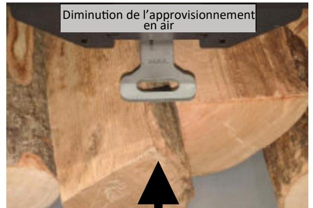
Quelle que soit la position de la commande, le levier peut avoir soit un minimum d'air de combustion, soit un maximum d'air de combustion.
